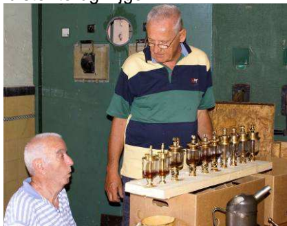
Wil en Henny bezig met het testen en instellen van de oliedruppelaars
