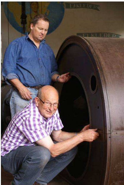
Wethouder Kees Rijnen volgt met belangstelling ons werk. Op zaterdag 25 augustus heeft hij een hele dag daadwerkelijk meegeholpen. Hier is hij met Bas bezig met het monteren van de kappen over een van de krukken
