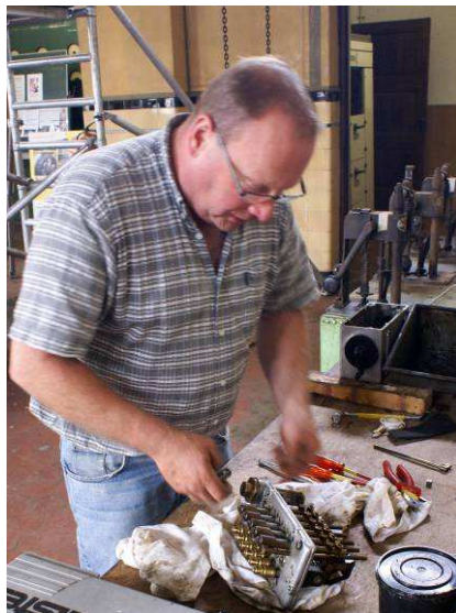
Arno bezig met de inspectie van een van de smeertoestellen
