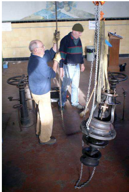
Felix en Wil bezig met het opnieuw monteren van het kleppenhuus dat ter wille van een inspectie tijdelijk van de machine verwijderd was
