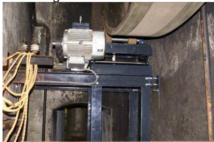
De aandrijving zoals gemonteerd onder het vliegwiel
