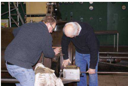
Bert en Arno in gevecht met de nieuwe smeerleidingen. Om lassen te voorkomen zijn alle leidingen uit een stuk gebogen
